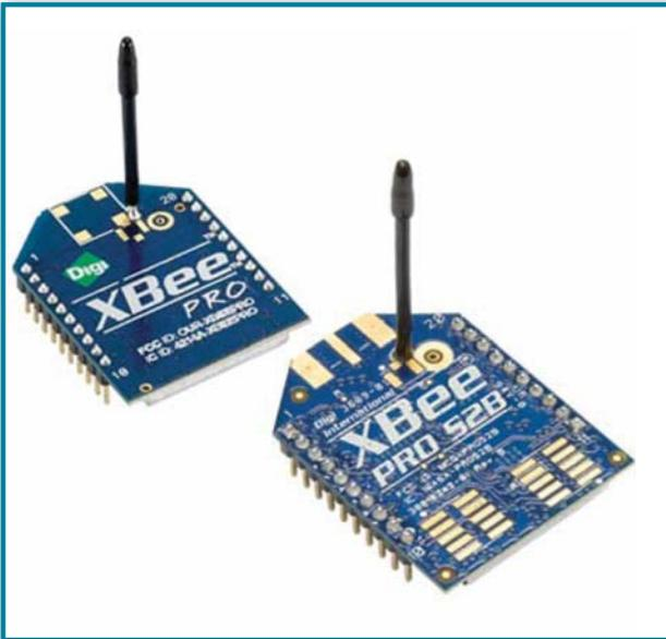
Рис. 3. Образцы беспроводных модулей M2M стандарта ZigBee
